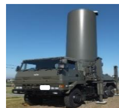
移動式警戒管制レーダー （TPS-102A）
