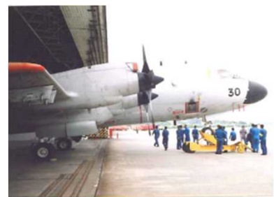
前脚を持ち上げた状態で 長時間かけて格納されるP-3C
