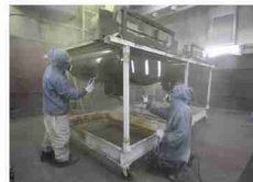
OD色を塗装中の水タンク
