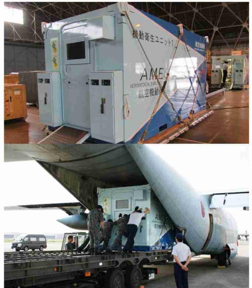
(上) 機動衛生ユニットの外観 (下) 機動衛生ユニットのCH-130H輸送機への搭載(訓練) (航空機動衛生隊提供)
