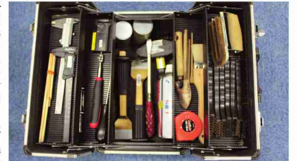
不発弾識別処理用具。ノギス、メジャー、真鍮ブラシなど普段身近な物で作業に当たる。
