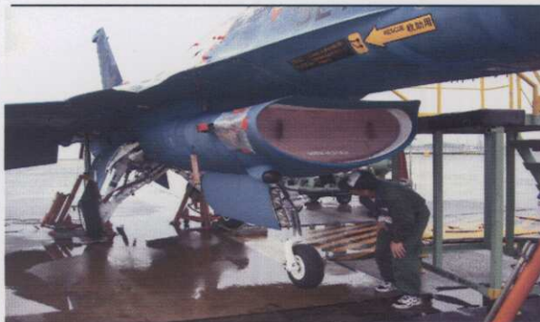
航空機の前脚室内の工程確認
