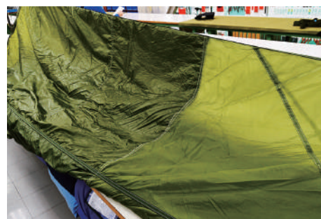
空気の透過性が異なるナイロン製の生地を縫い合わせた13式空挺傘の傘。色の薄い生地が、空気を通しやすい生地。
