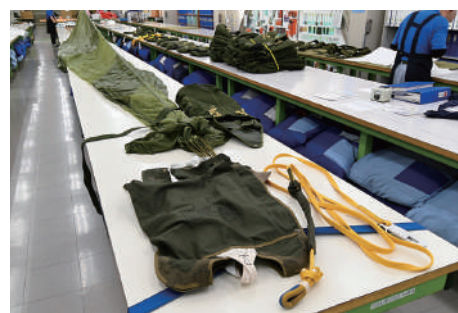
13式空挺傘の構成品。傘は、内う(左前)に収納され 航空機に固定された自動索(右前)で引き出される。
