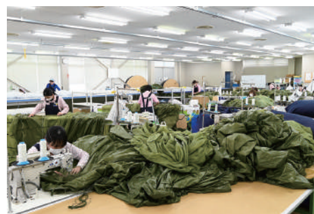
ミシンでパーツを縫い合わせ、13式空挺傘を製造している様子。生地面積は大きく、技術を要する。
