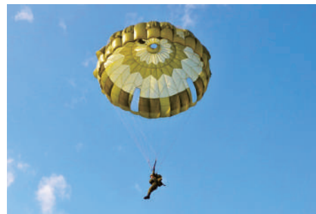
13式空挺傘(ひとさんしきくうていさん)。頂部のほか、4か所に穴が開いている。(写真:陸上自衛隊HP)
