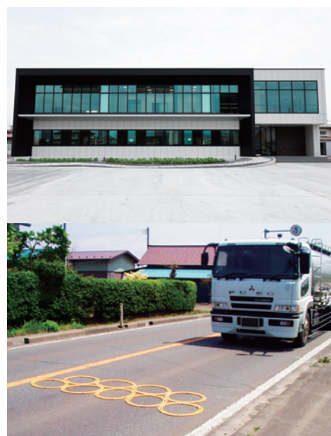
上北建設の社屋(上)とピタリング(下)。通過時の振動と音で、居眠り・脇見運転による工事現場でのもらい事故を防止。
