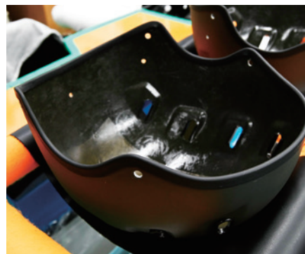
装甲車用のヘルメットのシェル。 傷が付いたときに目立たないように、 塗料を混ぜてFRPを成形している。
