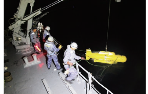
航走体の海中への投入
