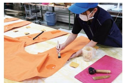
ハケで接着剤を塗り、パーツを貼り合わせる。写真は航空自衛隊の航空機搭乗員用の一人乗りの救命ボートのチューブ部分。
