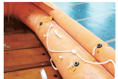
ゴムボートのチューブは、内側が隔膜で複数に区切られており、一部が破損しても、浮力を得ることができる。3つある円形の部品は、空気弁。
