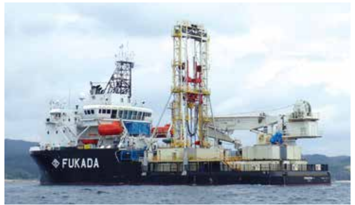
ボーリング調査を行う多目的作業船
