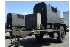
トレーラー（電源車）
