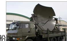
0H多重通信装置
