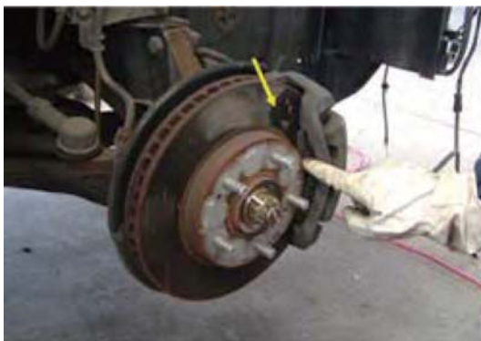
自動車のブレーキパッド。以前は、鉄粉、石綿その他混和材を入れディスクの摩耗の低減および制動効率のアップを図りました。修理・交換時に、摩耗して堆積した石綿含有粉じんにはばく露した可能性があります。
