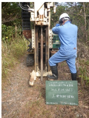
自走式ボーリングマシンによる採取
