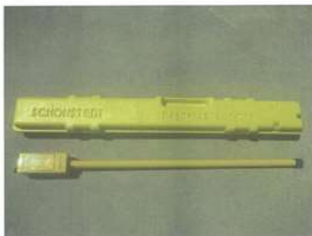
図5. 17 簡易探査機器（金属探知機）の例
