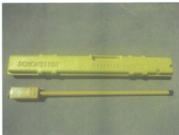
図 5-15 簡易探査機器（金属探知機）の例
