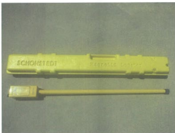
図 5-15 簡易探査機器（金属探知機）の例
