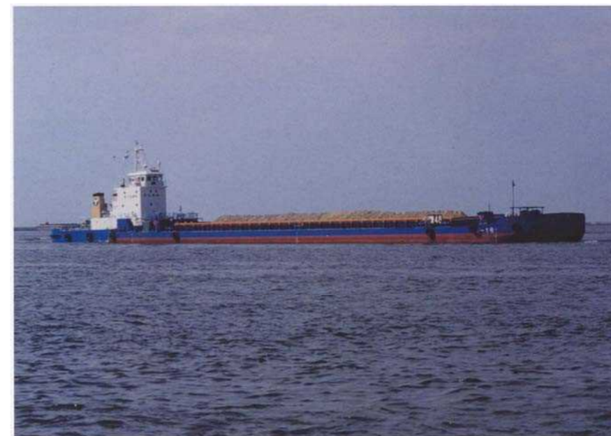
写 2.4-2 土運船運搬状況の例
