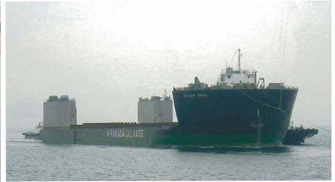
写 2.2-3 ケーソン運搬工(半潜水式台船)
