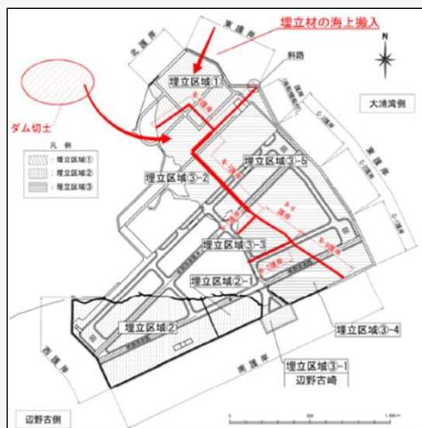
図1 中仕切護岸設置の平面図
