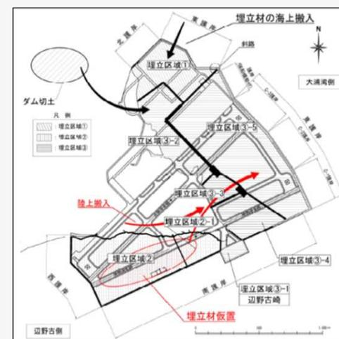
図4 埋立材投入量の増加平面図
