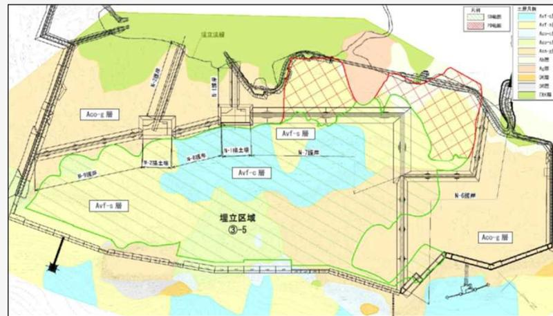
図2 中仕切護岸及び揚土場の平面配置図
