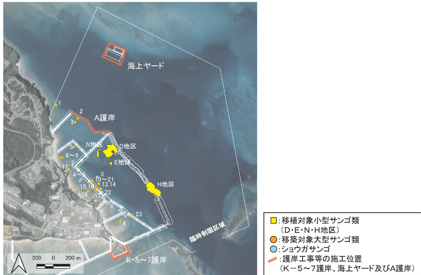
護岸工事等の施工位置及び移植・移築対象サンゴ類の位置
