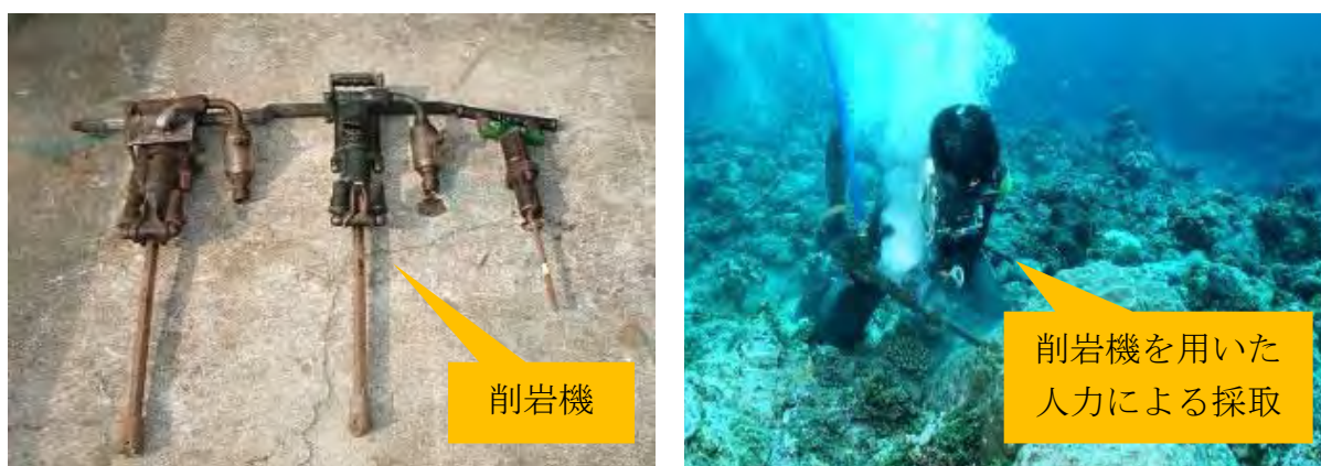
図-3.3.8 削岩機を用いた採取のイメージ
