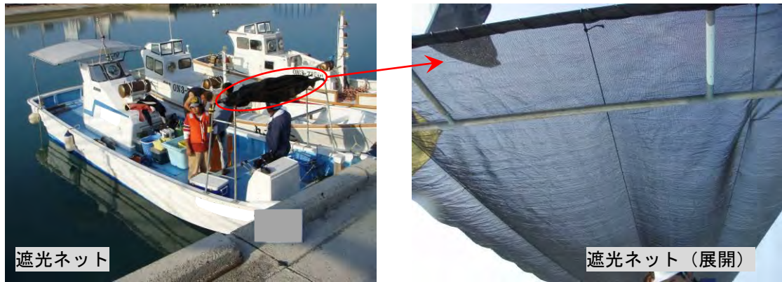
図-3.3.6 紫外線、水温上昇等を抑制するための遮光ネット
