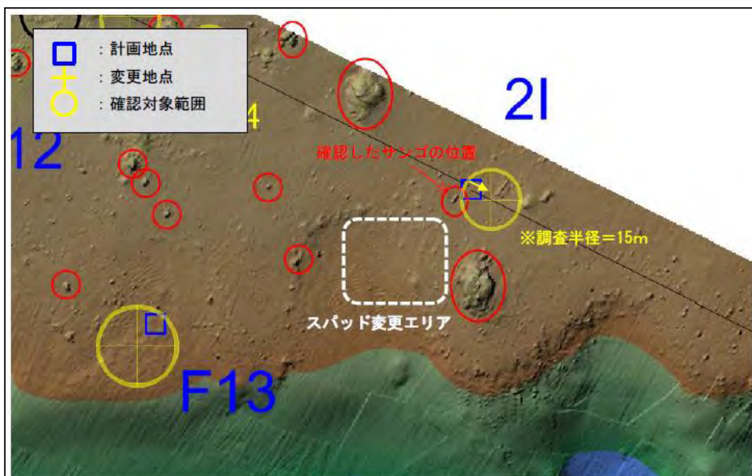
図 1-7 現地目視確認による地点変更の例（その 3） （浮標アンカー地点が移動したため作業船スパッド位置を変更）
