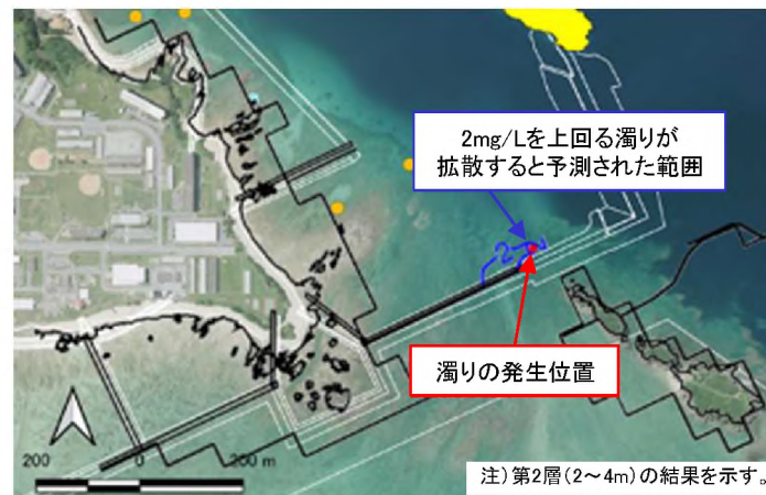
○K-8護岸100m延伸時(350m程度施工時)(夏季)
