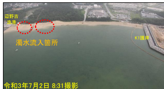
キャンプシュワブ西側の辺野古浜からの濁水流入状況
