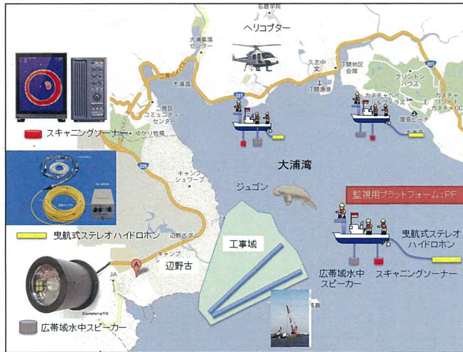
【工事海域監視・警戒サブシステム】
