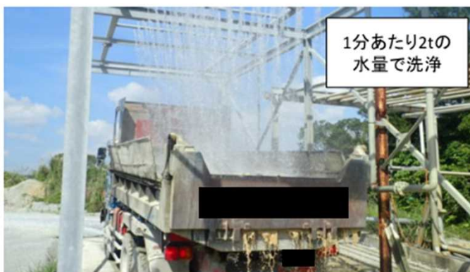
ダンプトラックに積んだ石材を洗浄
