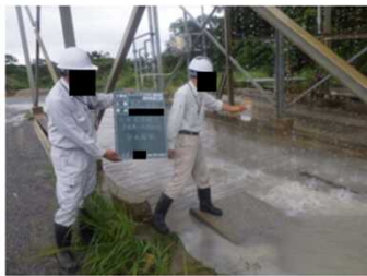
原水・洗浄水の採取（例）
