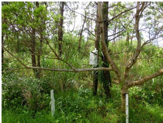
百葉箱内に温湿度センサーを設置
