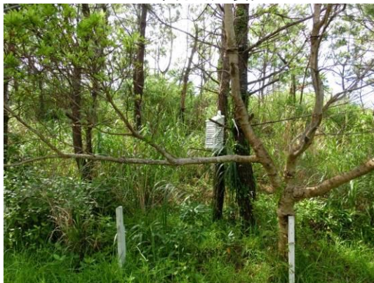
百葉箱内に温湿度センサーを設置
