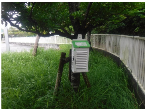
百葉箱内に温湿度センサーを設置
