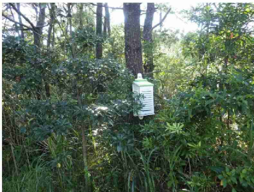
百葉箱内に温湿度センサーを設置
