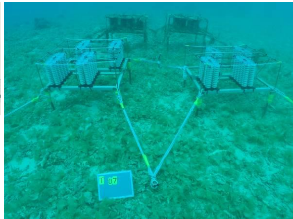
ステンレス製の架台(着床具4ケースを設置)を2台設置
