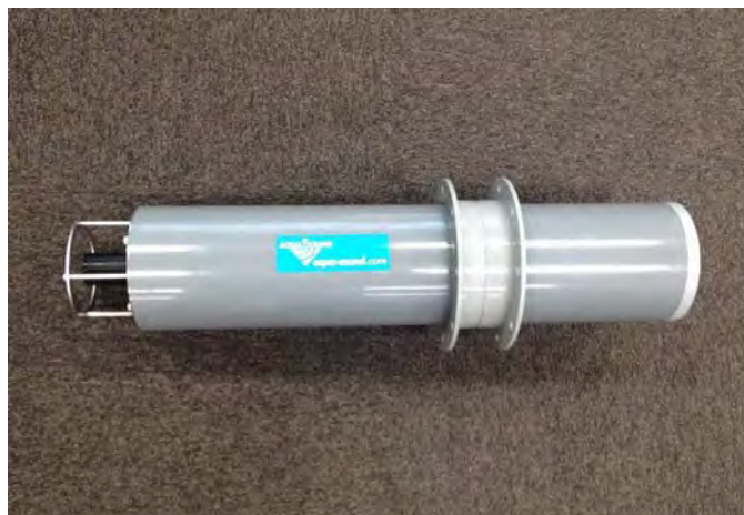
水中録音装置 表層係留型
