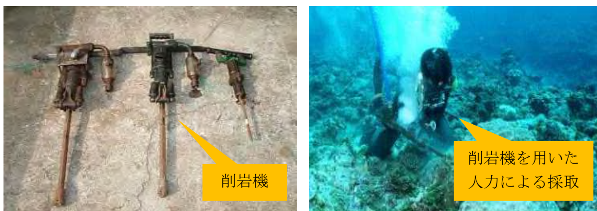
図-3.3.8 削岩機を用いた採取のイメージ
