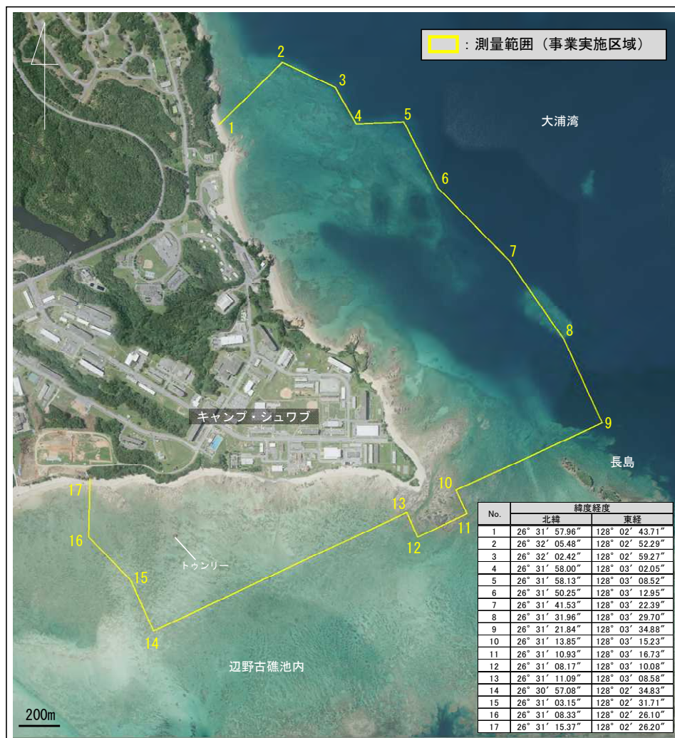
図-3.1.1 ナローマルチビーム測深機による深浅測量の実施範囲
