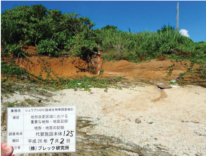
写真 (No.125①) 辺野古崎の岬の先端部の小高い高まりに嘉陽層を不整合に覆う洪積世の堆積物が観察される。
