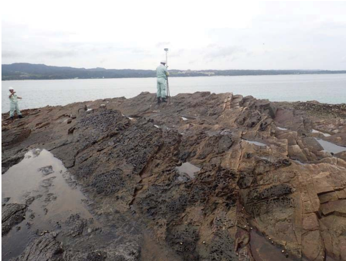
写真 (No.111②) 同上。 地質は嘉陽層の砂岩・泥岩が卓越する互層で、走向・傾斜は、N10W、29(W)で、西向きに傾いている。
