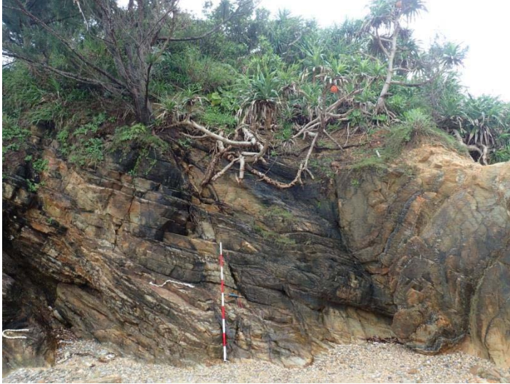
写真 (No.832⑯) 南南東に面した大規模褶曲の露頭の南側に位置する北東向きの高さ3~4mの露頭。 赤白ポール付近とその右側約2mの位置に断層がみられる。
