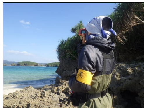
【距離計による高度の測定】
