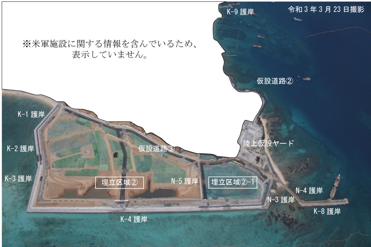
図-4.1.1.1 護岸工事及び埋立工事の位置
