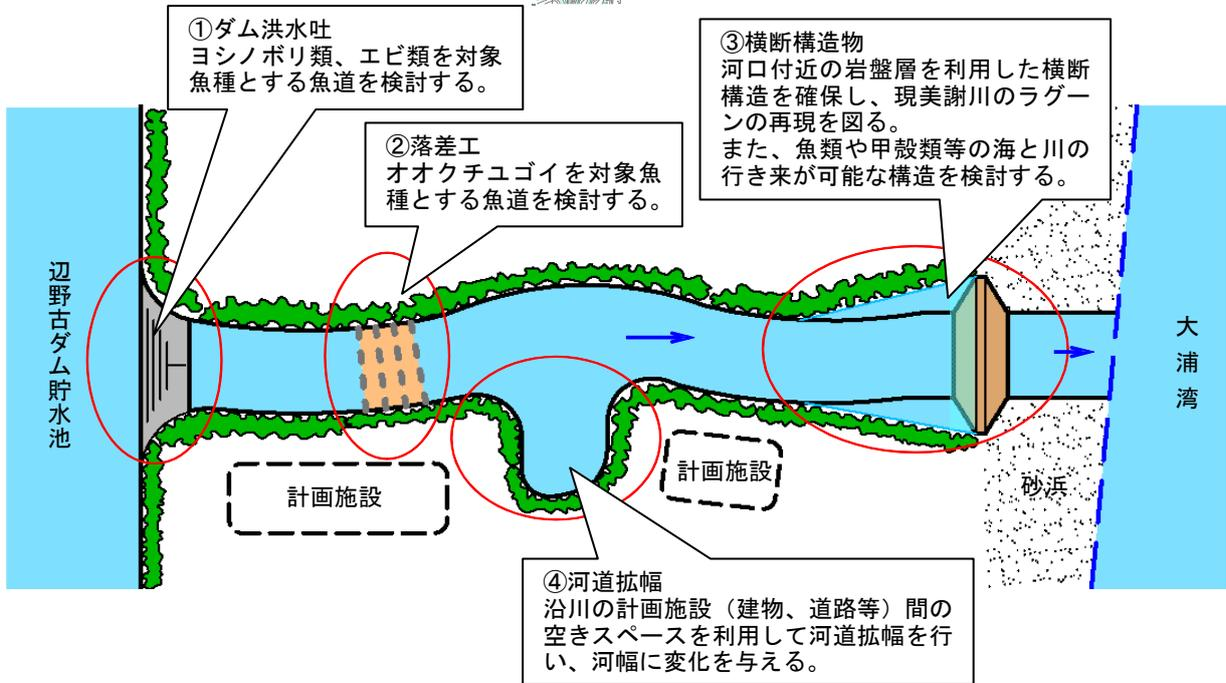
図-2.3.4.1 切替え水路（開水路部）の平面的イメージ
