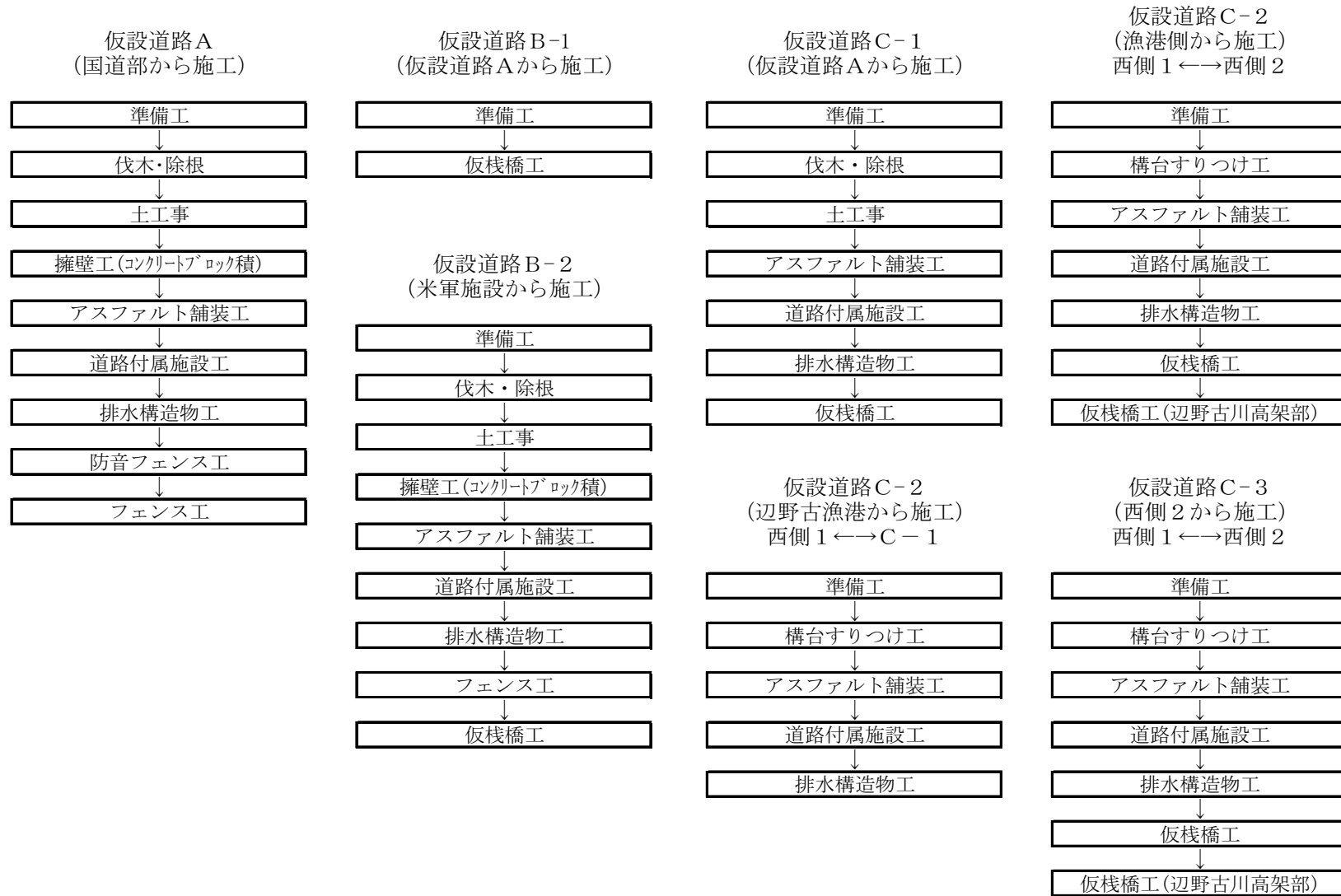
図-2. 4. 2. 64 工事中仮設道路施工フロー
