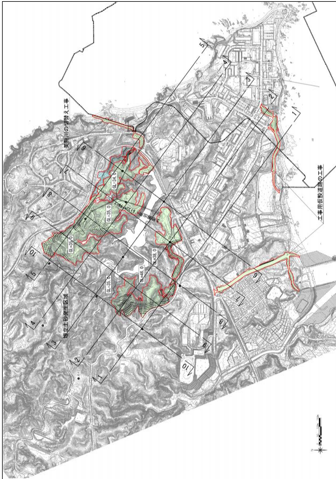
図-2.4.2.54 陸上工事に係る改変区域（埋立土砂発生区域、工事用仮設道路、工事用仮設道路の切替え）平面図
