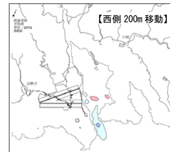
参考図-3(6) 埋立地の存在による流速変化域の出現状況（平成19年度の恒流（平均流）を再現した数値シミュレーションによる計算結果：第6層 [水深20m以深]）
