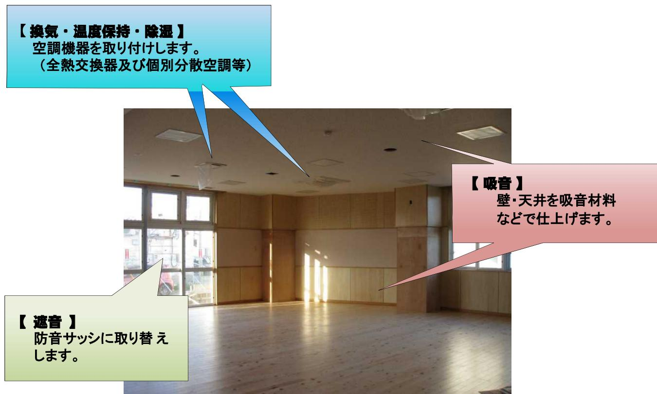
音響測定の結果によって、防衛省の定めた「防衛施設周辺防音事業工事標準仕方書」により工事（1～4級）を行って頂きます。
