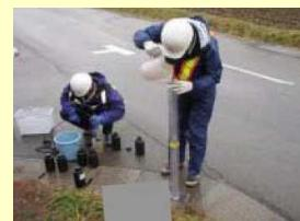
多項目水質計によるpH測定のイメージ
