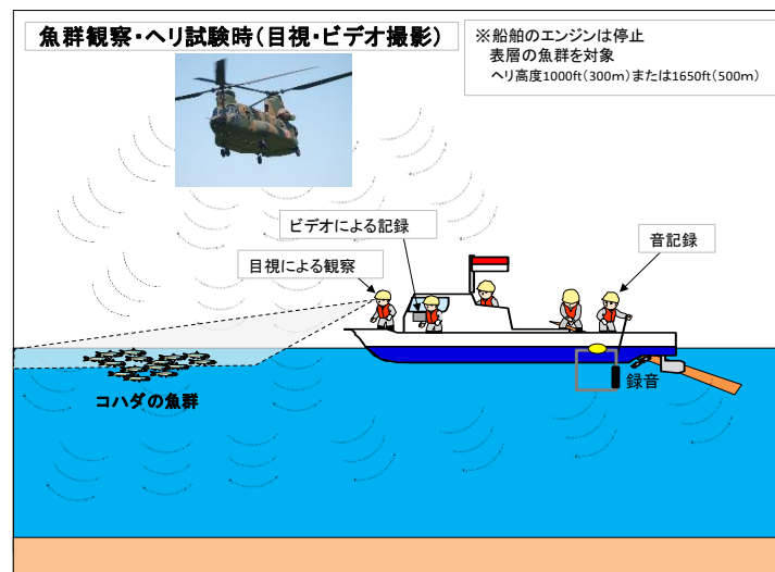
図1 ヘリ実機による試験状況(目視・ビデオ等による撮影)
