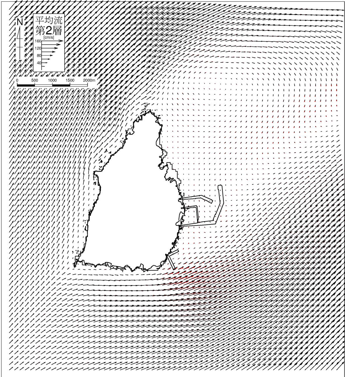
図-6. 9. 97(2) 流速ベクトル比較図 (現況と施設等の存在時の比較) (冬季：恒流 (平均流)) 第2層 (2.0~4.0m) 黒：現況、赤：存在時
