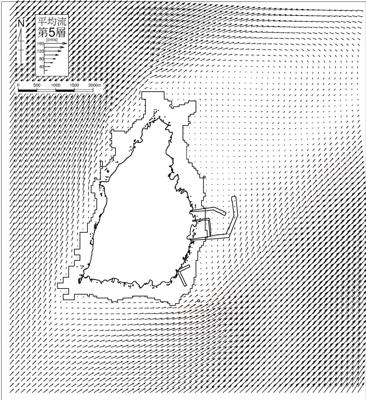
図-6. 9. 97(5) 流速ベクトル比較図 (現況と施設等の存在時の比較) (冬季：恒流 (平均流)) 第5層 (10.0~15.0m) 黒：現況、赤：存在時
