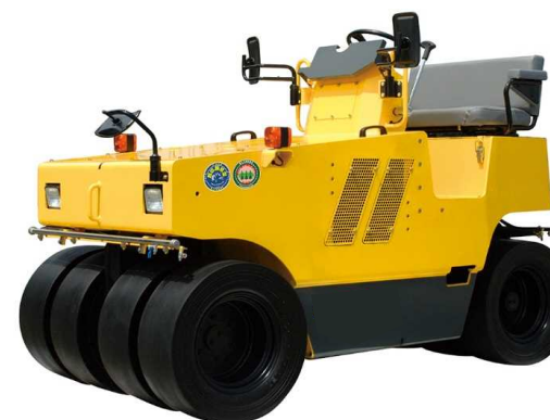
ロードローラー: 土の締め固め(転圧)に使用
