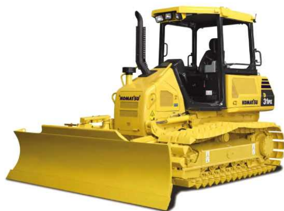
ブルドーザー: 土の押土に使用
