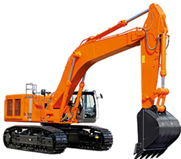
バックホウ: 土の掘削に使用
