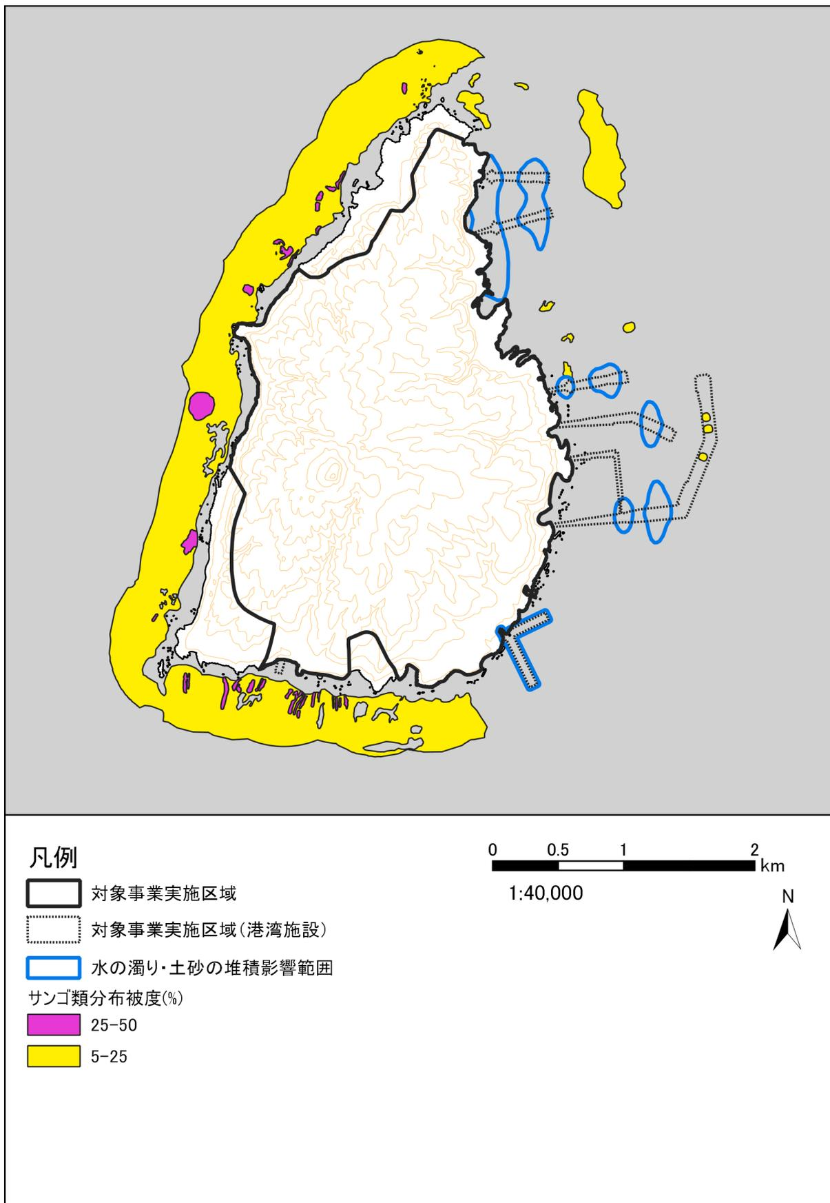
図-6.16.7 海上工事に伴う水の濁り・土砂の堆積（平常時）による影響を受ける可能性がある範囲とサンゴ類分布範囲
