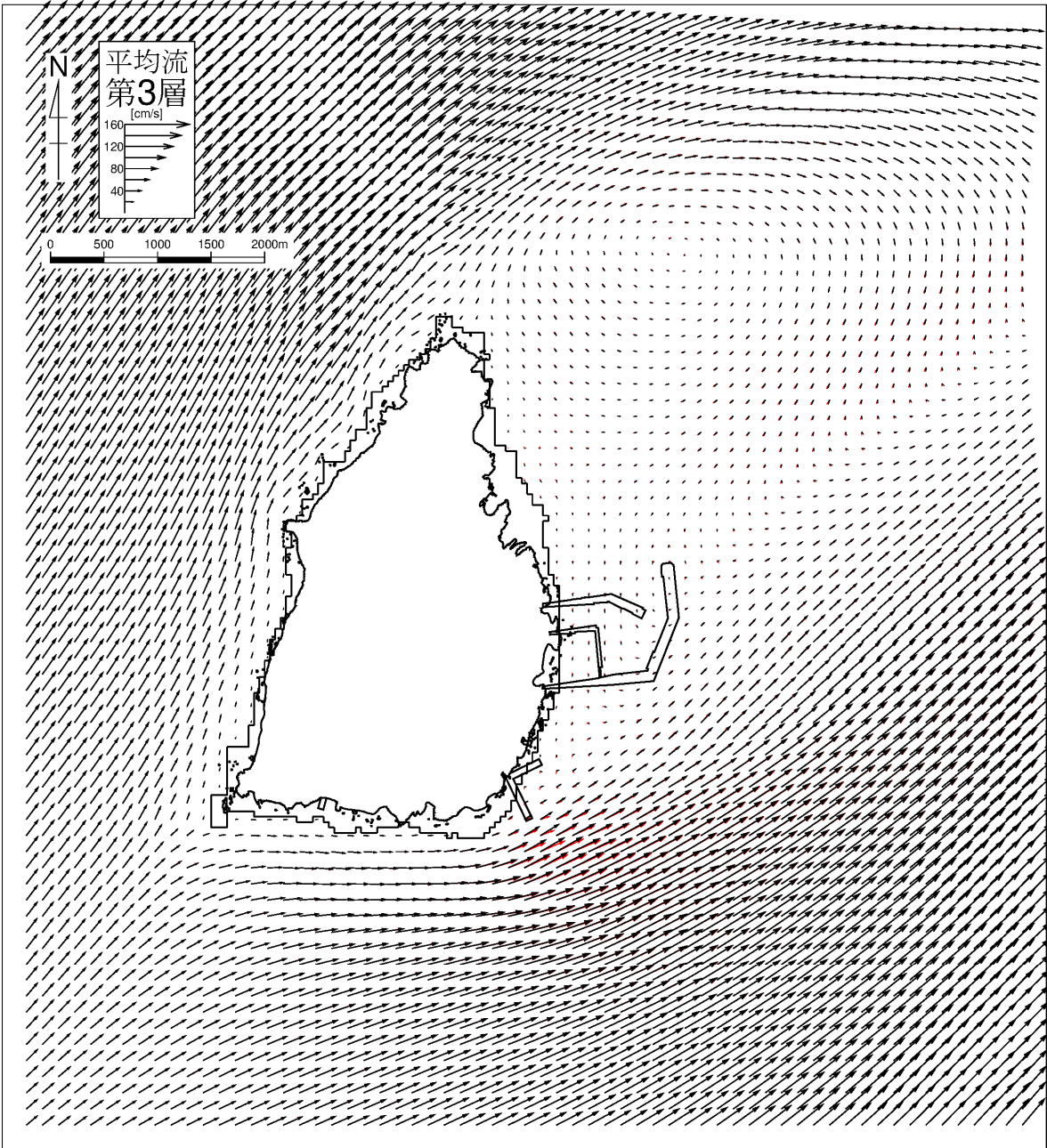
図-6.9.97(3) 流速ベクトル比較図（現況と施設等の存在時の比較）（冬季：恒流（平均流）） 第3層（4.0～7.0m） 黒：現況ケース、赤：将来ケース
