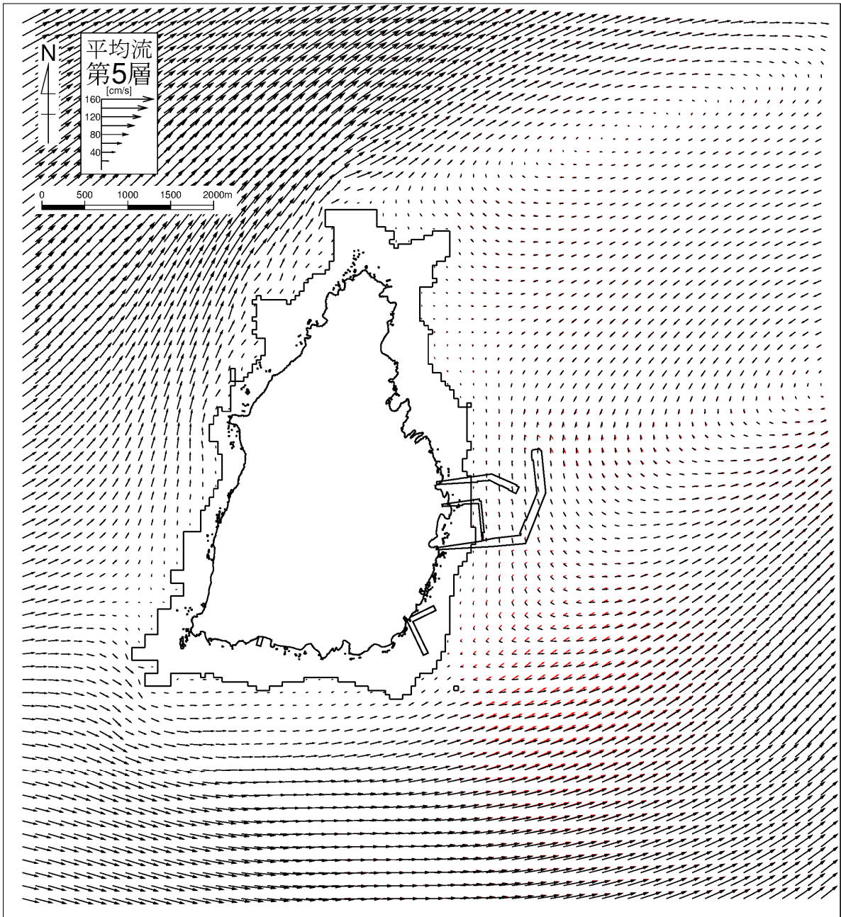
図-6.9.91(5) 流速ベクトル比較図（現況と施設等の存在時の比較）（夏季：恒流（平均流））
