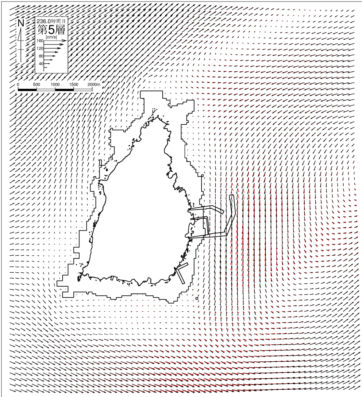
図- 6. 9. 90(5) 流速ベクトル比較図（現況と施設等の存在時の比較）（夏季：上げ潮） 第5層（10.0～15.0m） 黒：現況ケース、赤：将来ケース
