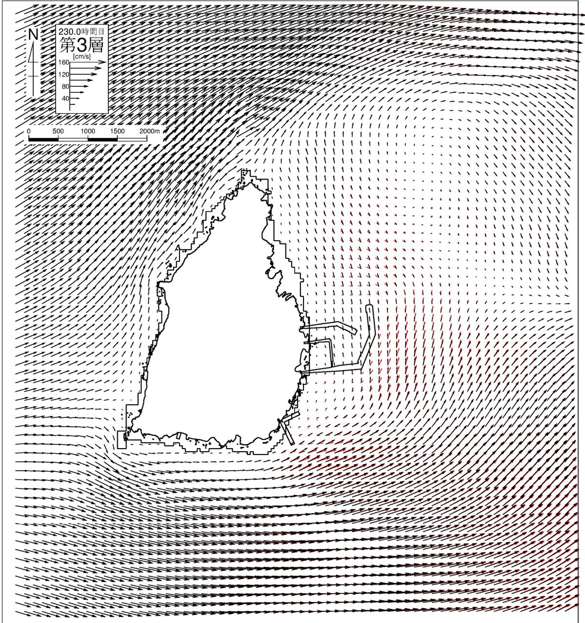
図- 6. 9. 89(3) 流速ベクトル比較図（現況と施設等の存在時の比較）（夏季：下げ潮）
