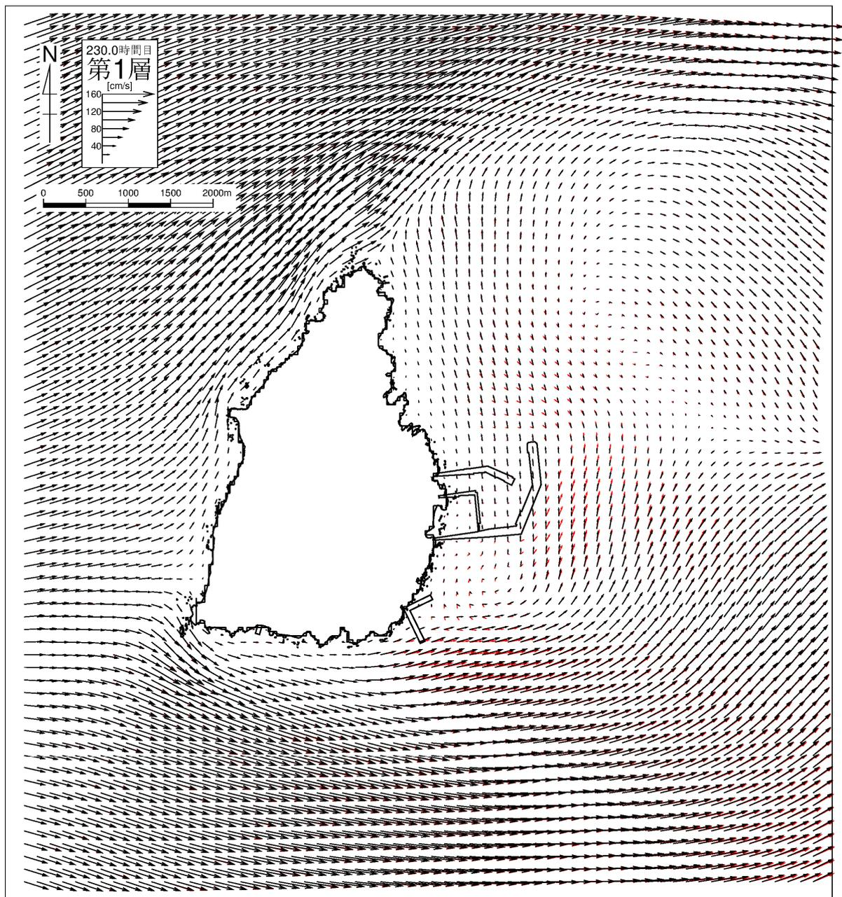
図- 6. 9. 89(1) 流速ベクトル比較図（現況と施設等の存在時の比較）（夏季：下げ潮）
